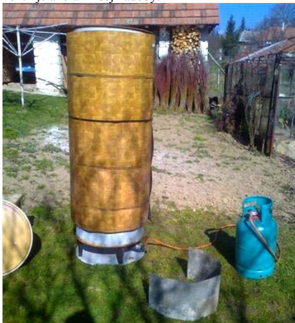
Obr. 26 Za ideálneho počasia už za 10 minút bol viditeľný únik pary cez poistný ventil.
