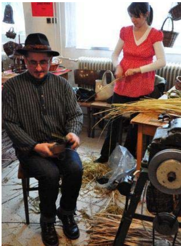
Obr. 28 Zuzana Nikodémová šúpe ručnou šúpačkou parené prúty uralky a Petrik Beňo ukazuje ručné hobľovanie lubkov. V popredí je mechanický hoblík. Foto: Vladimír Brezinsky
