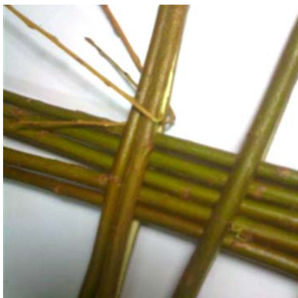
Obr. 12 Zalomenie okolo páru rozštiepených prútov umožní mierne upevnenie prútov, ktoré môžete od samého začiatku opletania utahovať.
