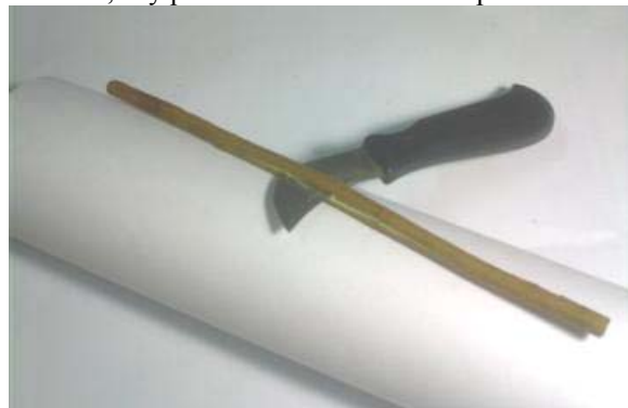
Obr. 2 Ak by bol prút príliš krátky, mohol by sa rozštiepiť po celej dĺžke.
